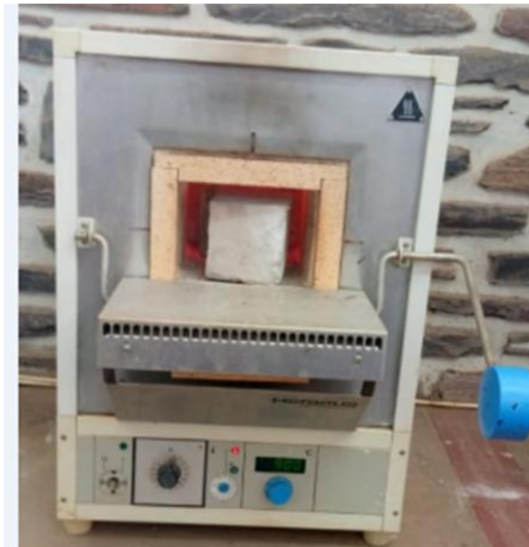
Figure II.8 : environnement intérieure du four programmé à 900
