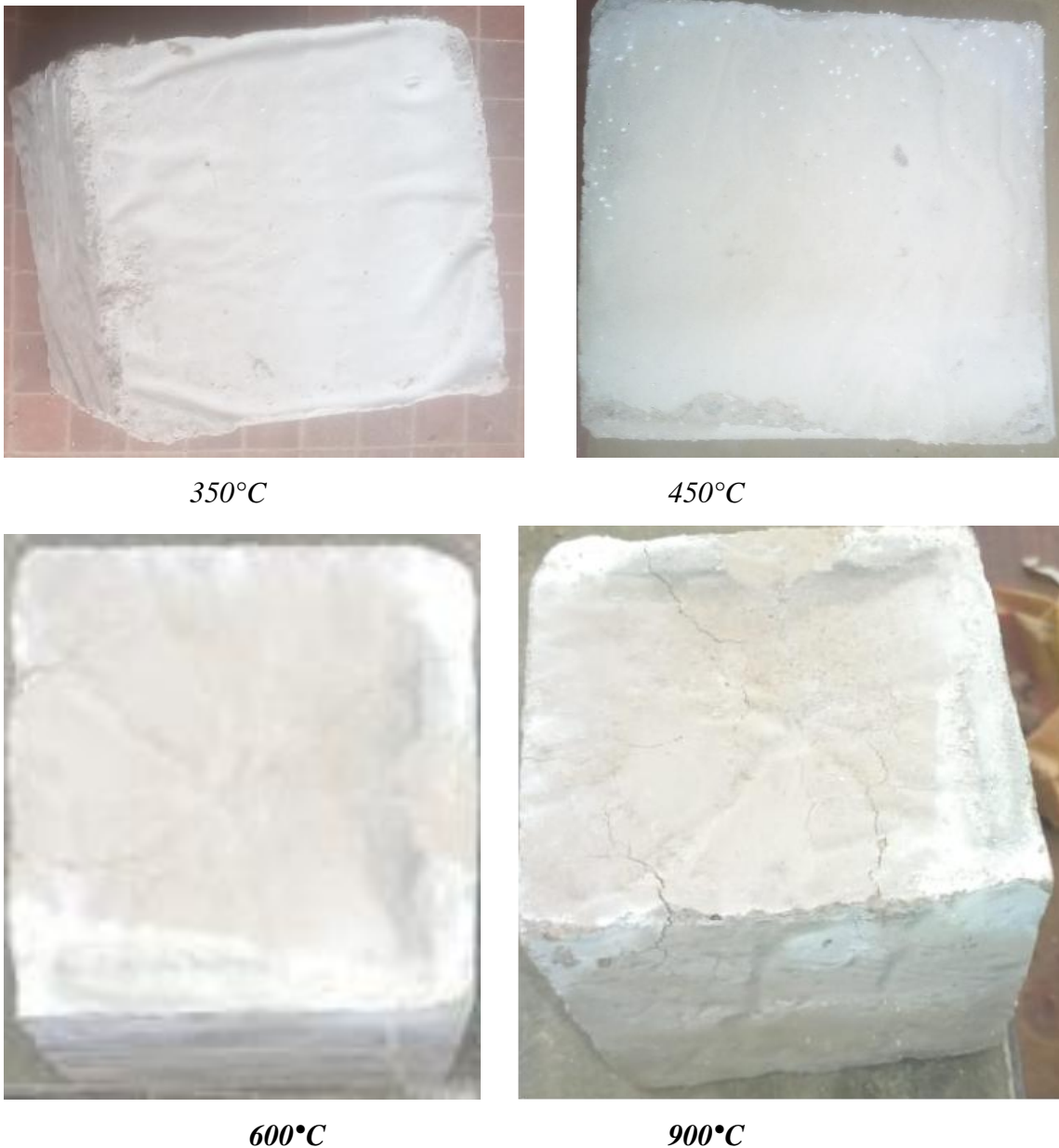
Figure III.6 : Photographies des échantillons avant et après exposition aux différentes températures.
