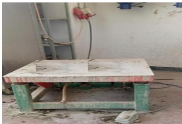
Figure II.4 : Equipement de compactage du béton (Table vibrante)
