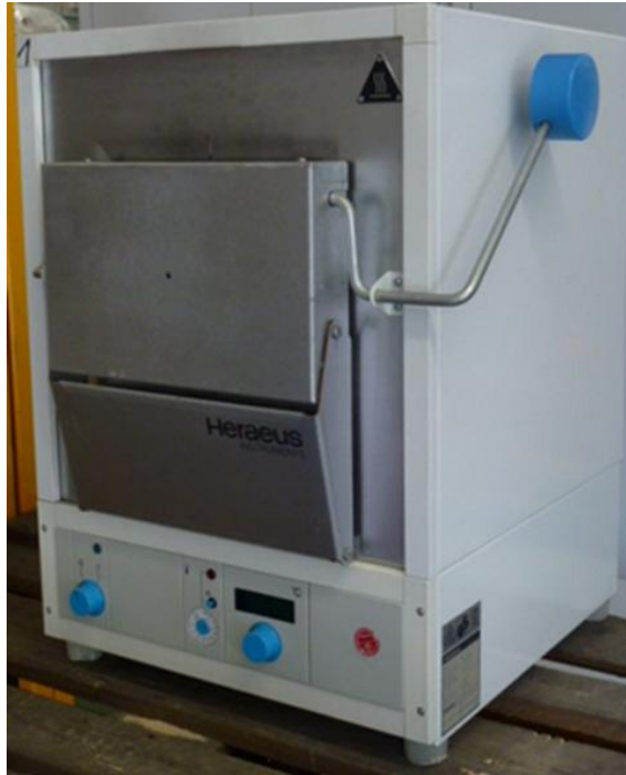
Figure II.7 : À gauche, photo du four électrique Heraeus M104
