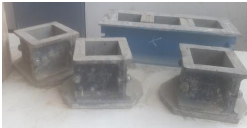
Figure II.3 : Moules 10 X 10 X10 cm utilisés pour la confection des échantillons
