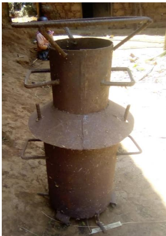
Figure 2 : Four pyrolytique qu'on utilise pour la production de biochar (photo prise sur le terrain)
