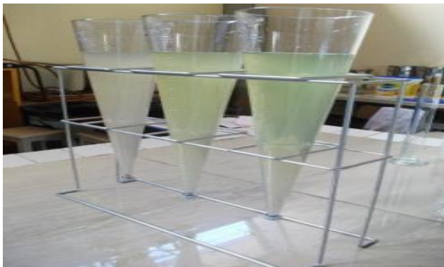
Figure 11: Montage pour déterminer les matières décantables
