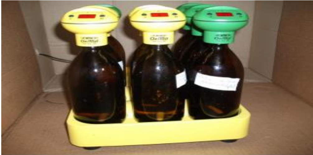
Figure 13 : Dispositif expérimental de mesure de la DBO
