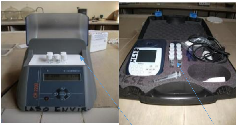
Figure 12 : Mesure de la DCO : a) Minéraliseur. b) Photomètre Palintest.
