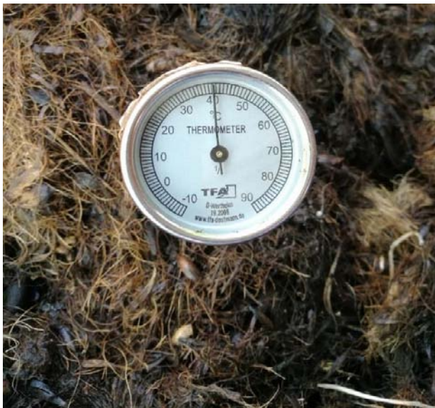
Figure 4: Thermomètre de mesure de température de déchets de palmier à huile en fin de pré-compostage
