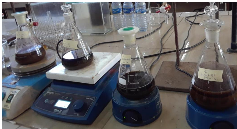
Figure 8 : Montage de macération sous agitation pendant 24h
