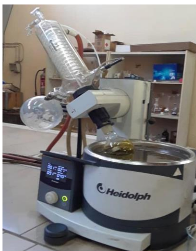
Figure 9: Montage de l'évaporation du solvant extracteur sur évaporateur rotatif sous pression réduite à 40°C
