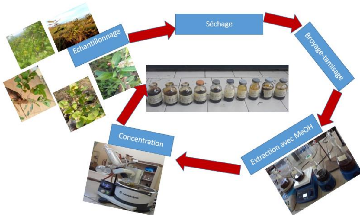
Figure 11 : Résumé schématique des différentes activités réalisées pour obtenir les extraits secs
