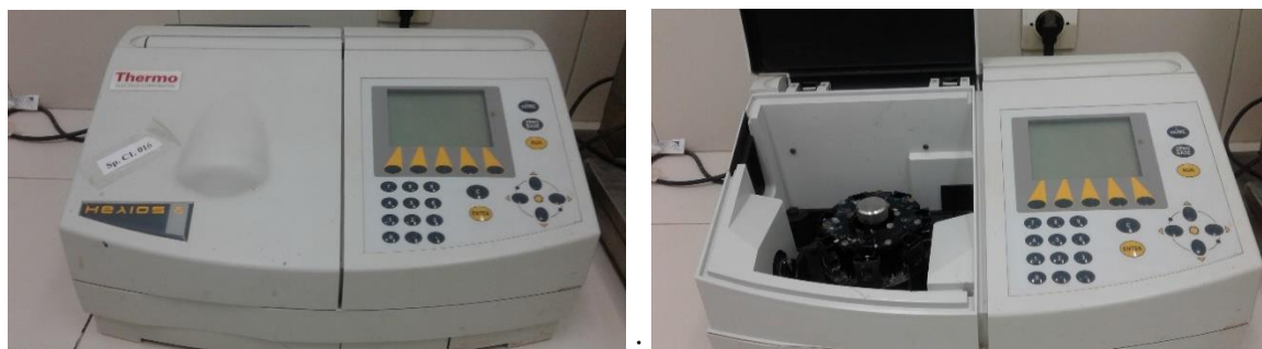
Figures III 1a & b): photos du spectrophotomètre utilisé.
