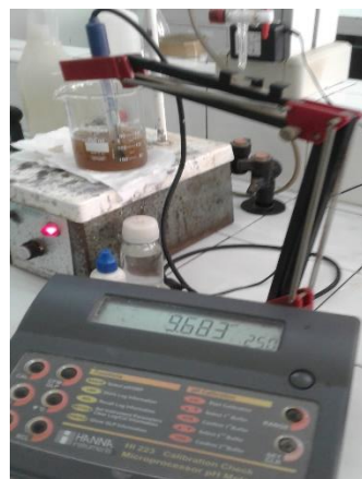
Figure 11: photo de mesure du pH de la suspension du compost
