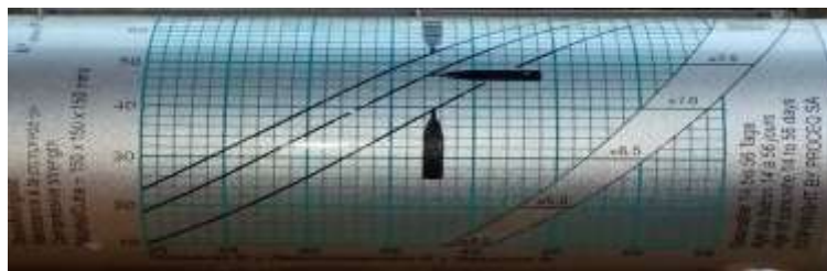
Figure 2.6 – Abaque sur le scléromètre permettant de définir la résistance en compression du béton à partir de la mesure de rebond.
