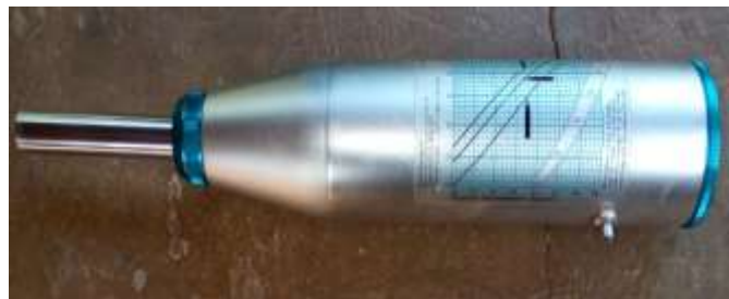
Figure 2.1 – Scléromètre utilisé dans l'identification des résistances en compression du béton des colonnes, poutres et dalles des bâtiments concernés par l'étude.
