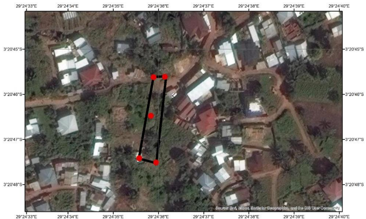
Photo 19 : Disposition des points de sondage
