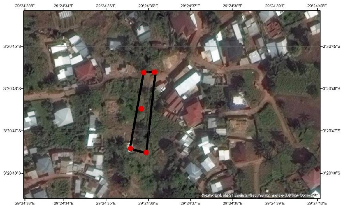
Photo 13: Disposition des points de sondage
