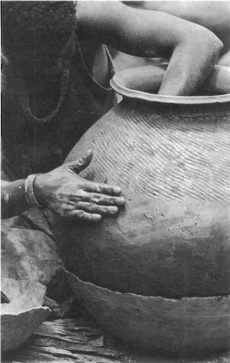
La potière décore les parois encore humides avec une petite tresse de jonc.
