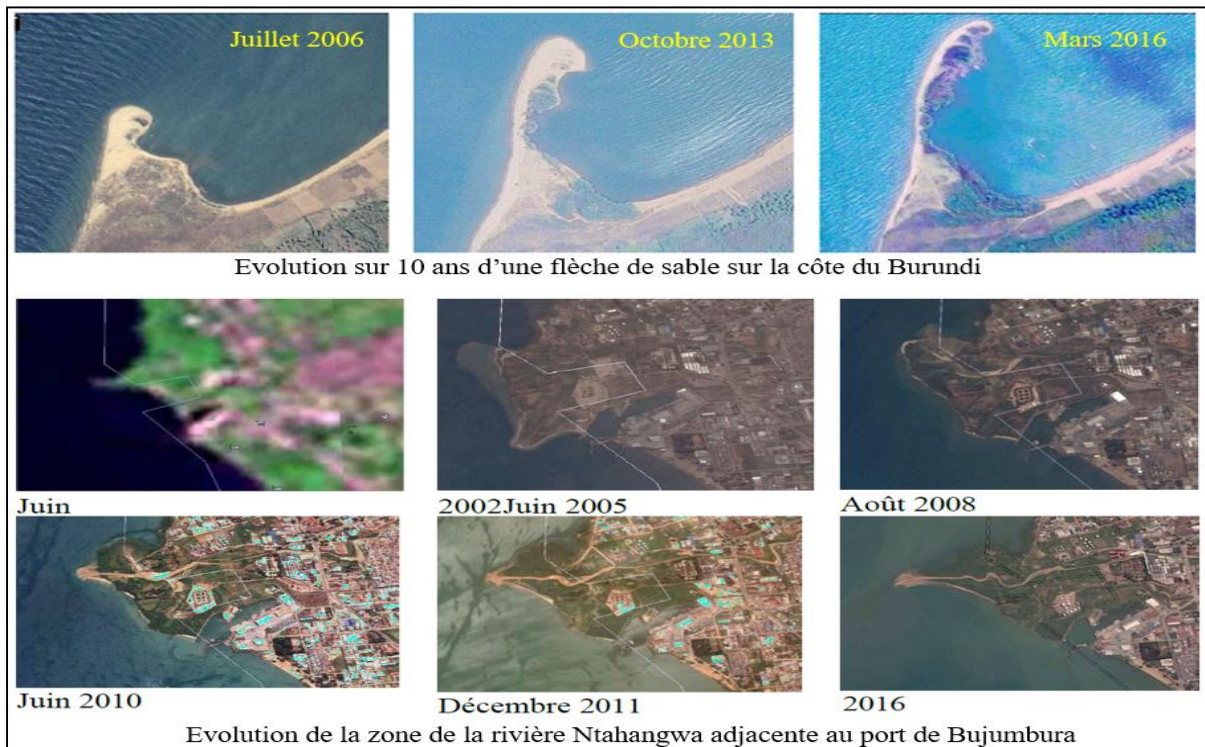
Figure 17 : Sédimentation du port de Bujumbura suite à l'érosion du BV Ntakangwa (Serrat-Capdevila et al., 2020).
