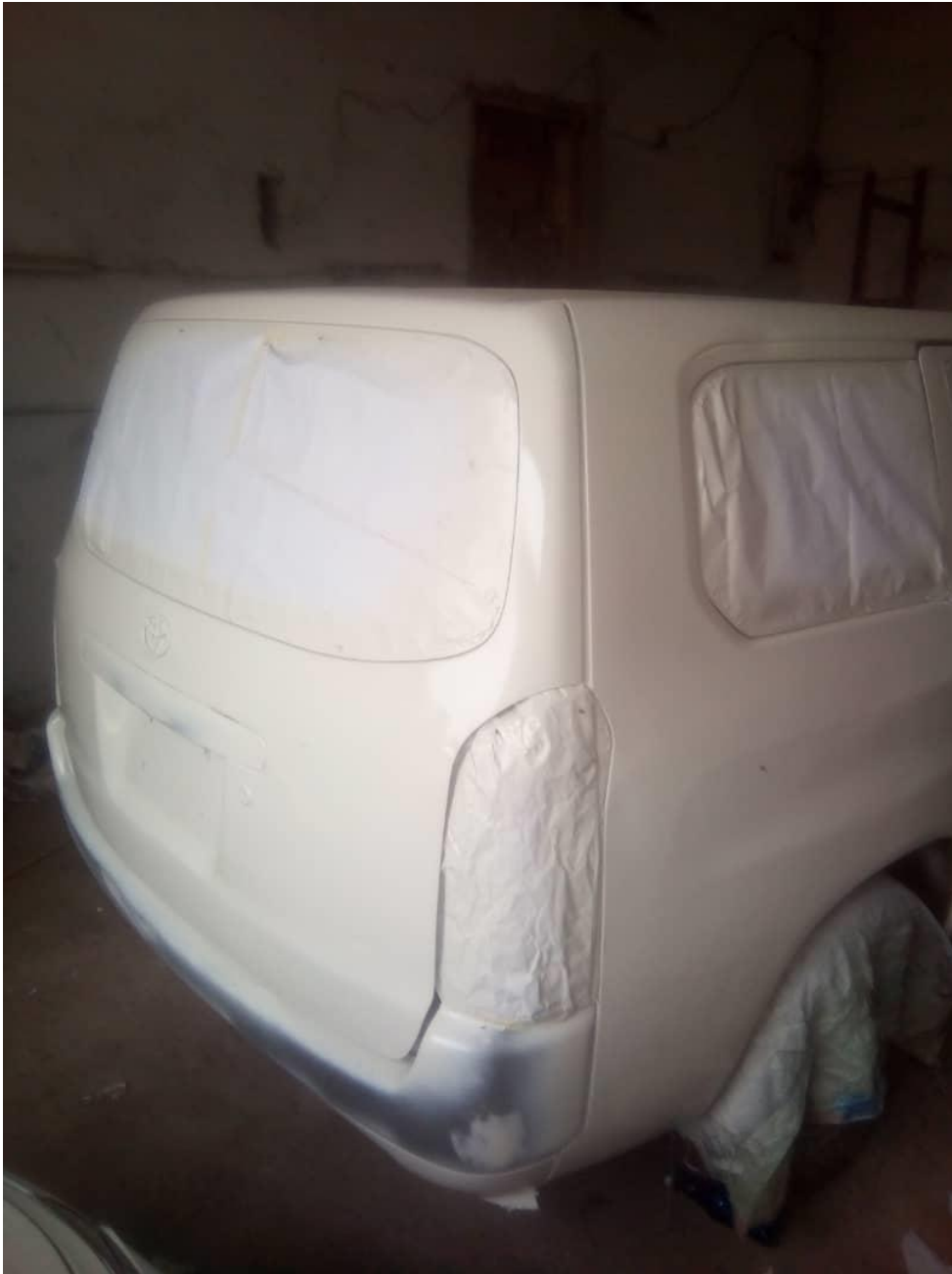
Photo 1 : Une voiture avec une nouvelle couche parfaite après travail de ponçage
