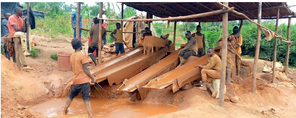
Figure 8: Concentration de l'or par sluice sur le site Nyarubuye kw'ishonga
