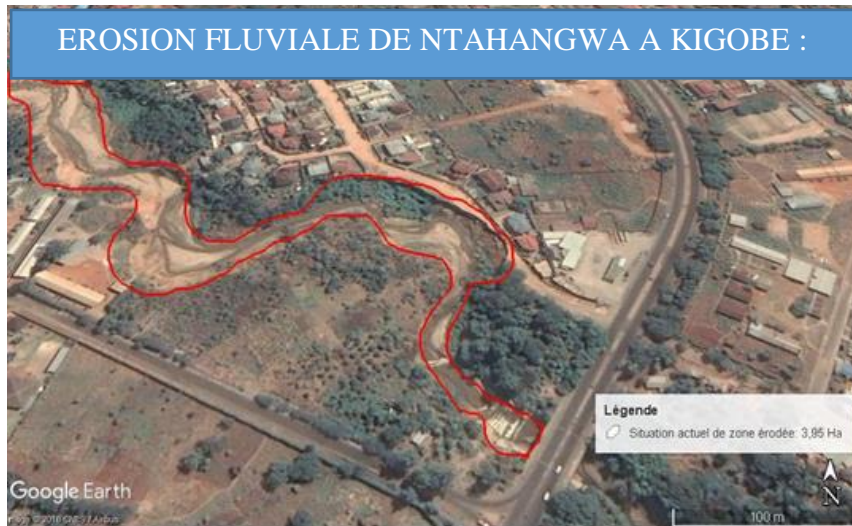
Figure 9: État 2018 de l'érosion hydrique de la rivière Ntakangwa dans le quartier de Kigobe
