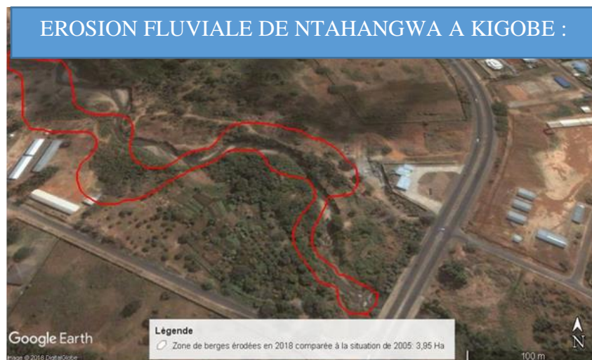
Figure 10: État 2005 de l'érosion hydrique de la rivière Ntakangwa dans le quartier de Kigobe
