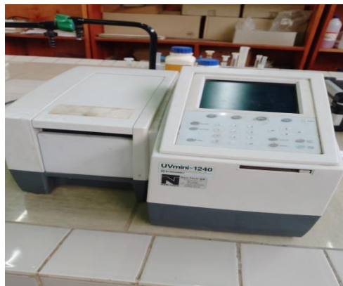
Figure 6. Spectrophotomètre UV-Visible utilisé pour déterminer le taux d'HMF
