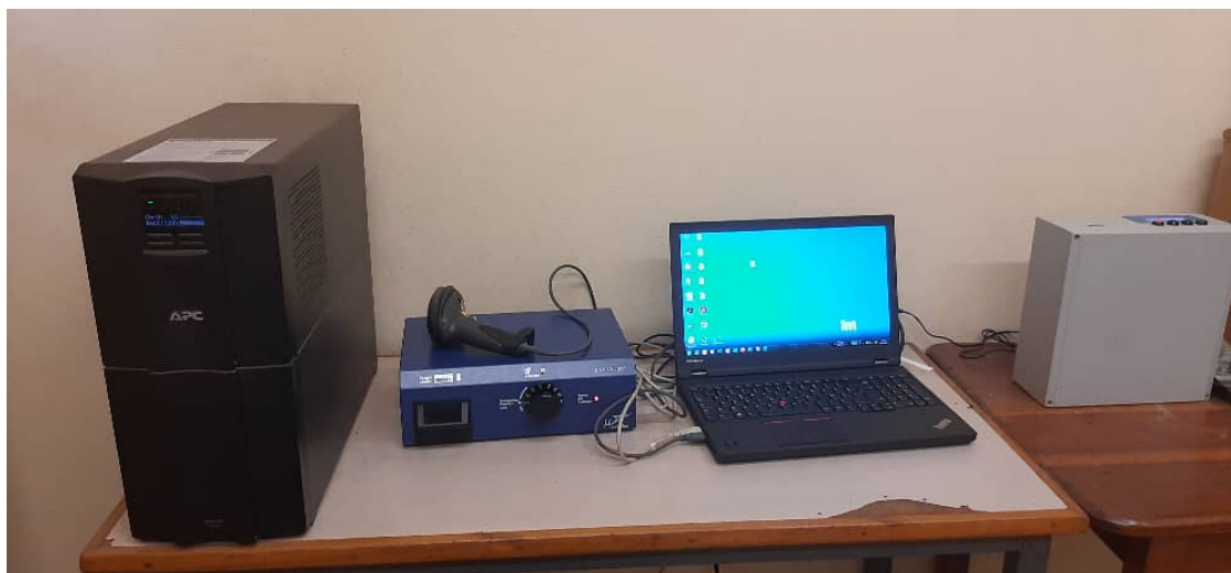
FIGURE 1.4 – Photo de l'appareil Landauer MicroSTAR (Photo prise par l'auteur au labo de l'INSP).
