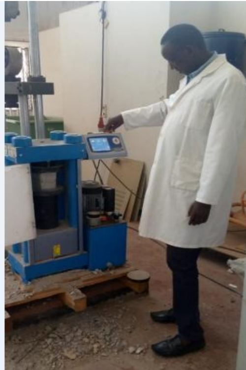
Figure II.11 : Programmation de l'essai de compression
