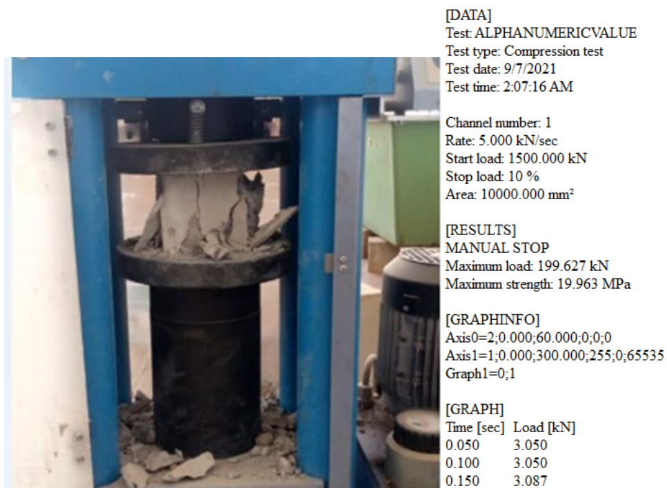
Figure II.12 : Aperçus de la propagation des microfissures dans l'éprouvette et format des résultats obtenus après écrasement
