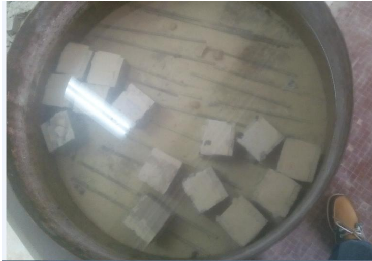
Figure II.6 : Conservation des éprouvettes immergées dans l'eau.
