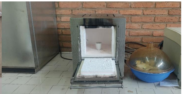
Figure 4: Capsule contenant l'échantillon dans le four.
