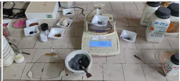
Figure 8: Pesée d'un échantillon de cendres de briquettes de biomasse.
