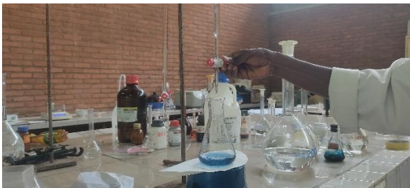
Figure 7: Titrage avec la solution d'EDTA 0.01 M
