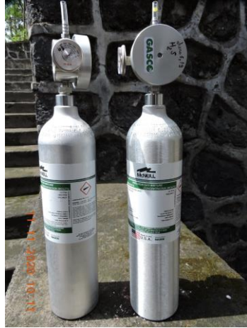
Figure 12. Bouteilles de gaz étalons pour le calibrage du MultiGAS, munies de soupapes régulatrices de pression
