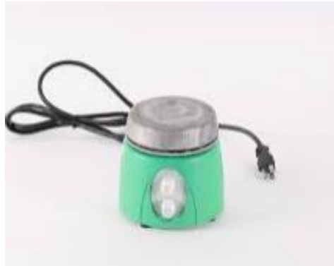
Figure 7: Photographie d'un agitateur électrique utilisé
