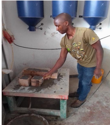
Figure III.2:Vibration des échantillons sur une table vibrante.
