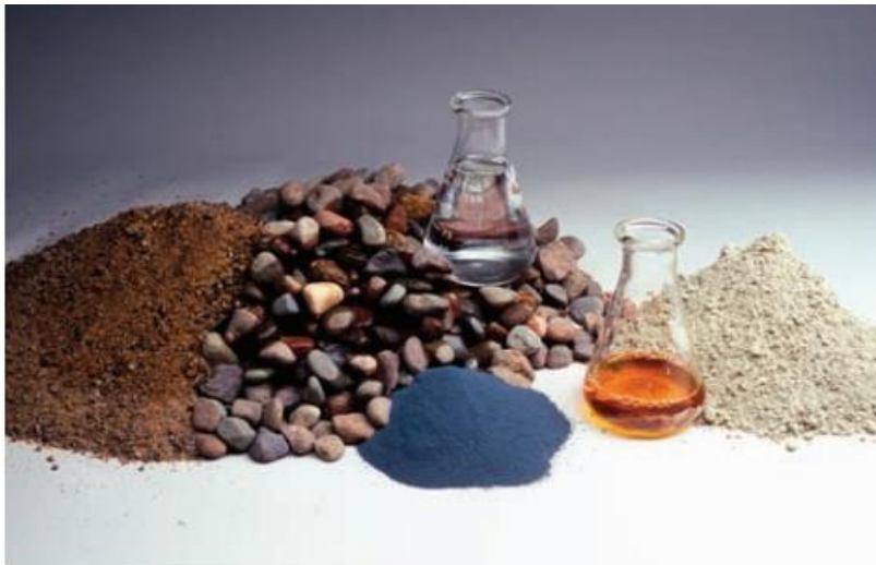
Figure I.1: Les composantes du béton et ses éventuels ajouts (NF EN 206-1).
