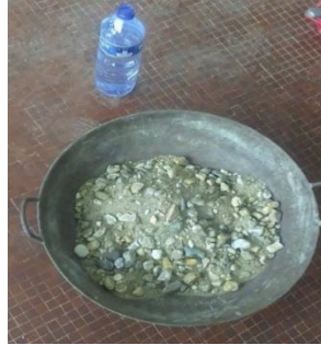
Figure III.1: Mélange des ingrédients à sec.
