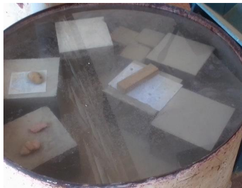
Figure III.3:conservation des spécimens sous l'eau pendant 28 jours.
