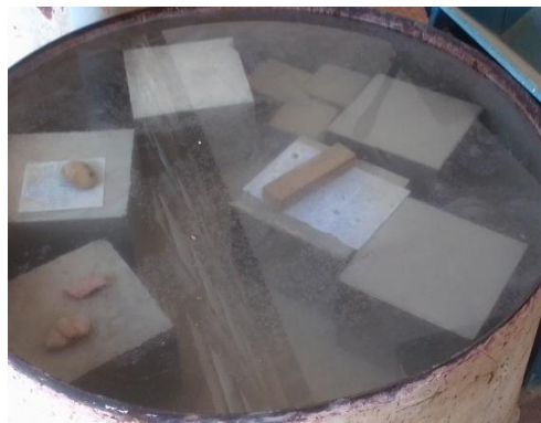
Figure III.3:conservation des spécimens sous l'eau pendant 28 jours.
