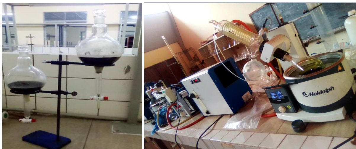
Figure 3. 11. Illustration du dispositif d'extraction des principes actifs
