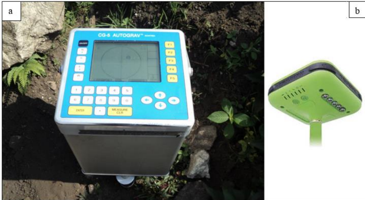
Figure 3.2: Equipements utilisés pour l'étude gravimétrique : a) Gravimètre Scintrex CG-5 ; b) Javad DGPS
