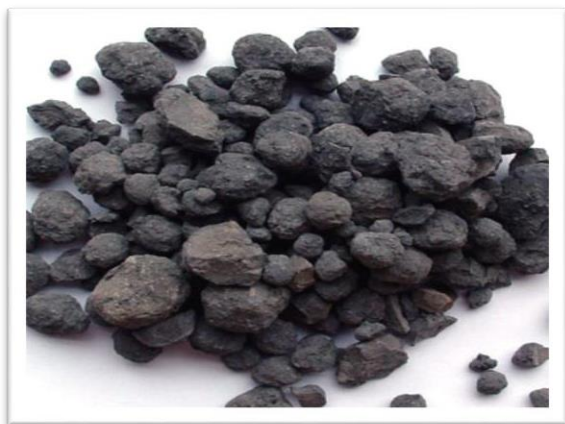
Figure 3: Aspect du clinker après refroidissement (Mounsif, 2018)
