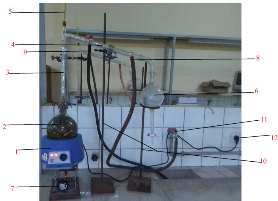
Figure 7 : Montage expérimental d'appareillage de type Clevenger utilisé; (1) chauffe-ballon ou manteau chauffant électrothermique, (2) ballon, (3) colonne de Vigreux, (4) réfrigérant ou
