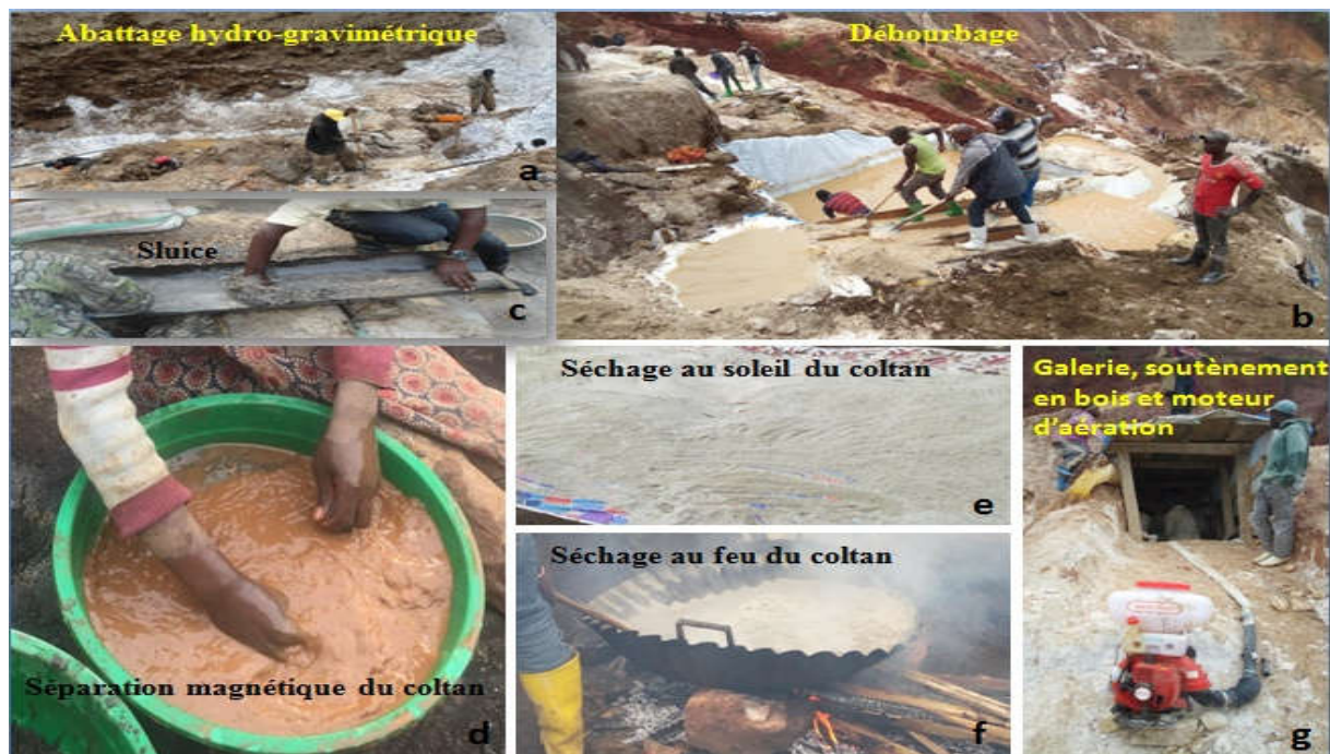
Figure 8: Etapes d'exploitation et du traitement des minerais de Rubaya
