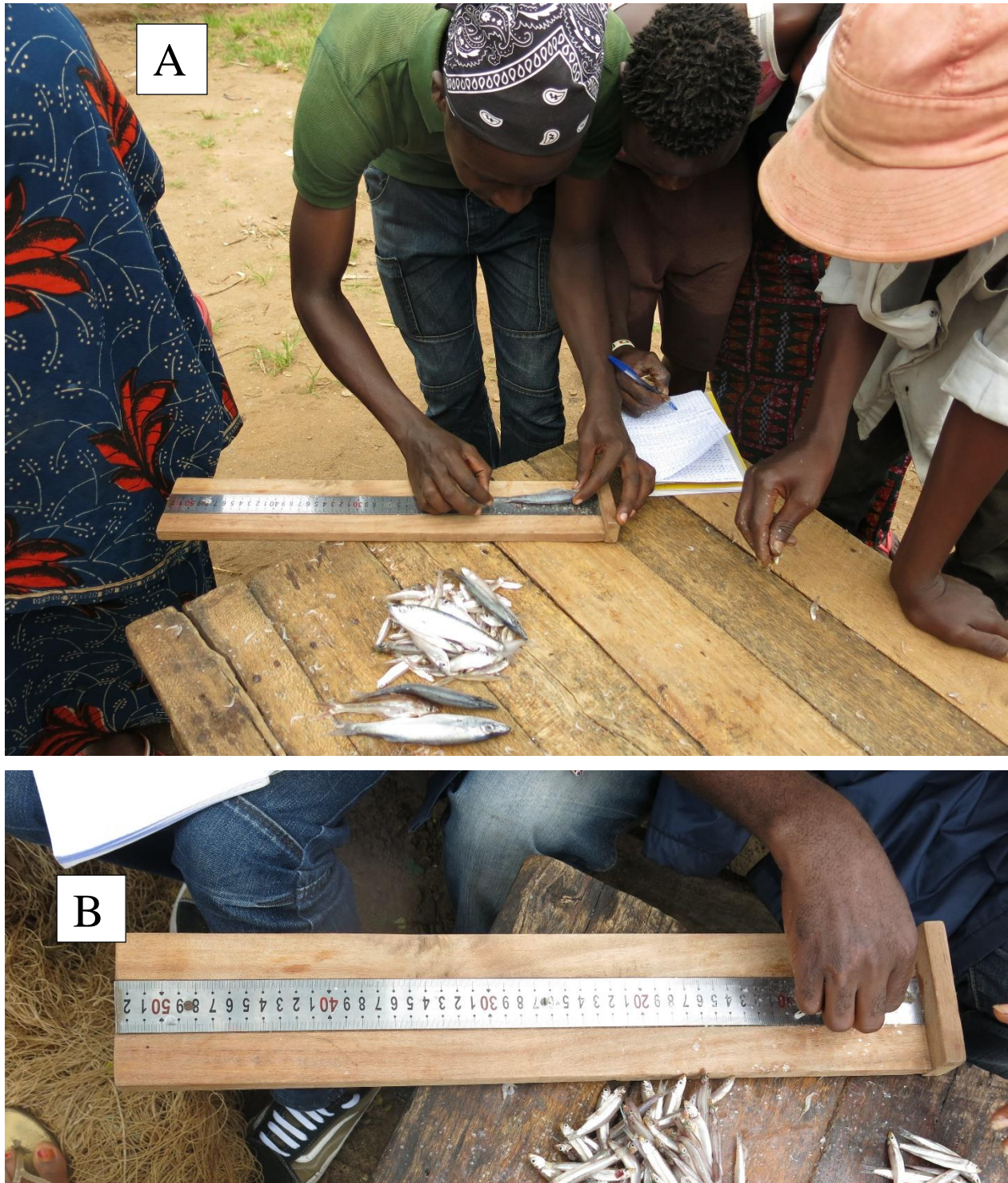
Figure II.3: Mensuration des poissons et enregistrement des longueurs dans un cahier (A) et l'ichtyomètre utilisé (B).
