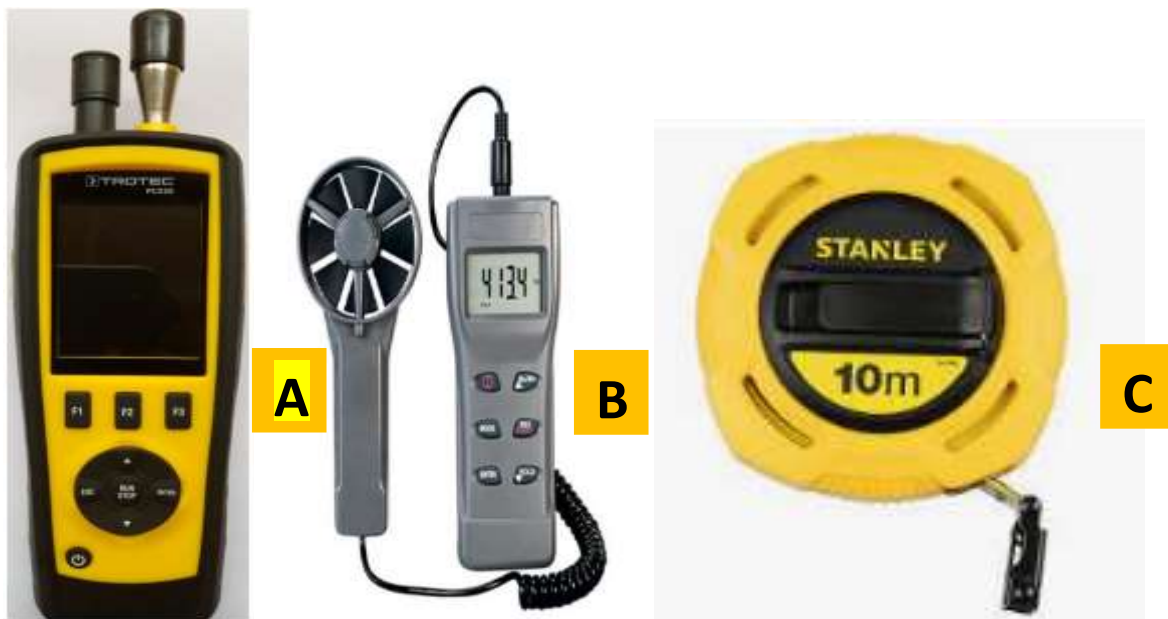
Figure 11: L'appareil TROTEC modèle PC220 (A), l'anémomètre série HHF11A (B) et le décimètre (C).
