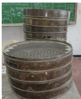
Figure III-9 : Tamis utilisés pour l'analyse granulométrique
