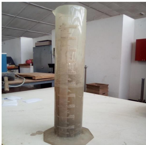
Figure III-7 : Mesure de la masse volumique absolue
