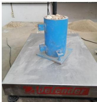
Figure III-8 : Mesure de la masse volumique apparente
