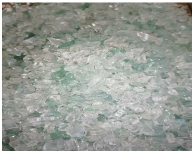
Figure III-5 : Image illustrant les verres broyés
