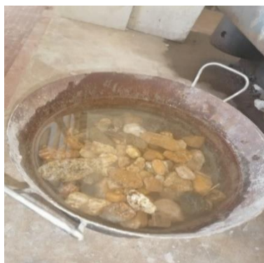
Figure III-8 : Image illustrant l'absorption d'eau
