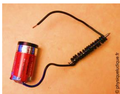
Fig. 29. Enroulement du fil de cuivre autour du clou ou du tournevis.
