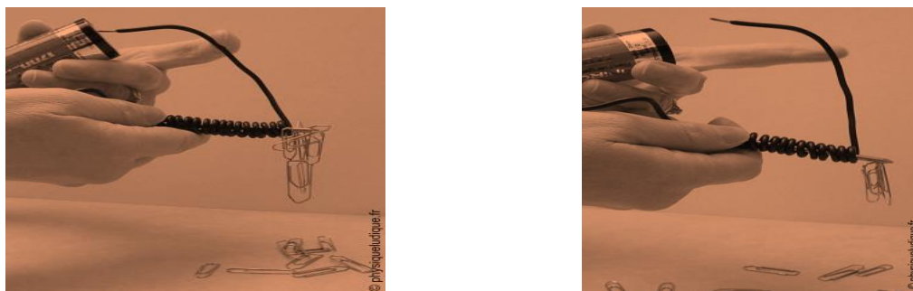
Fig.32 : Déplacement du dispositif avec les trombones et ouverture du circuit électrique
