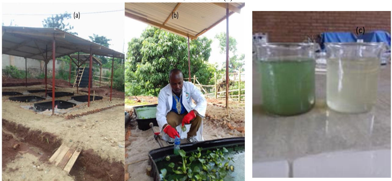
Figure II : Schéma du pilote expérimental ayant sévi pour le traitement en modes continu et discontinu des eaux de rejet de la STEP de Buterere au Burundi avant (a) et pendant (b) les essais et aspect de l'effluent avant après traitement (c)
