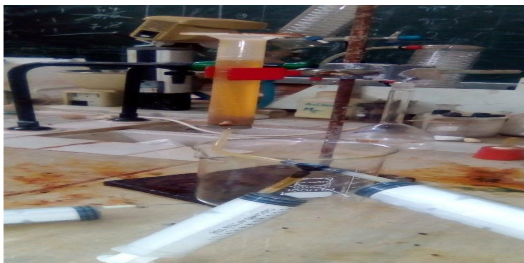
Figure 6 : Dispositif de caractérisation du Biogaz
