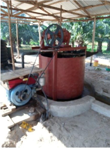
Figure 5. Photo d'un dispositif jouant le rôle de pressage et de malaxage relié à un moteur
