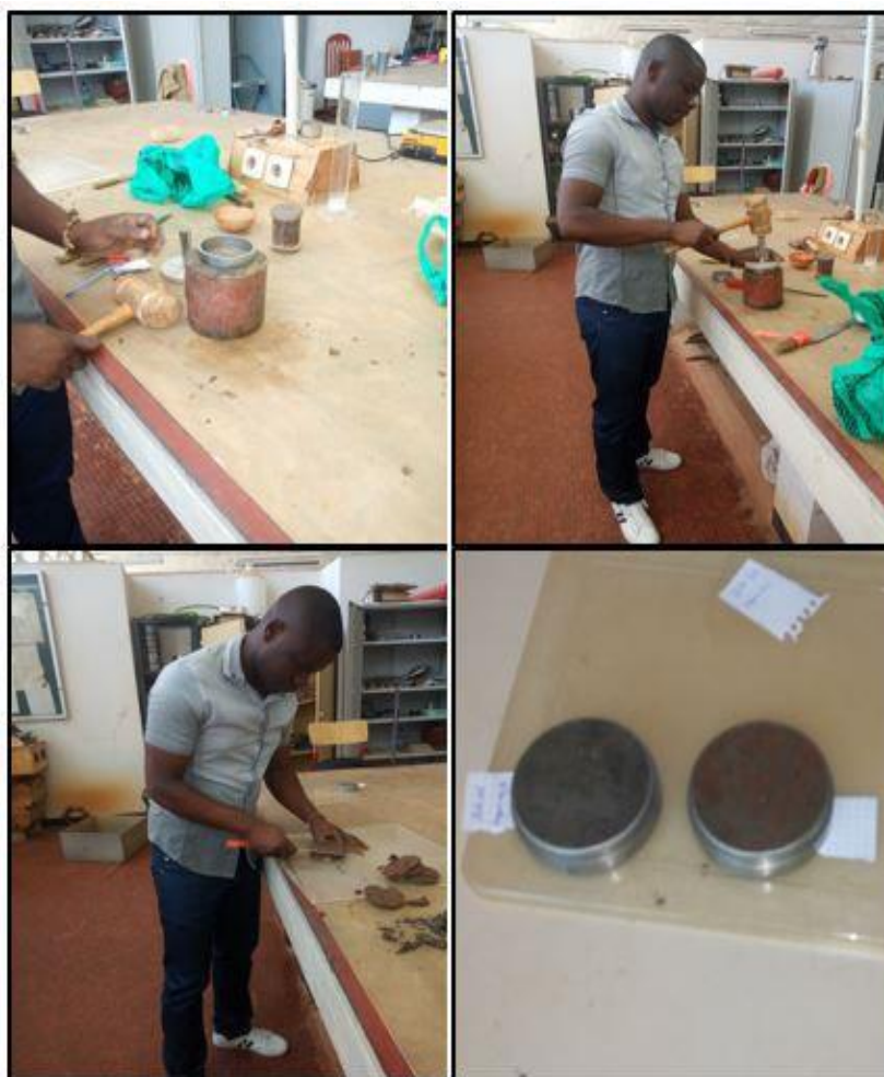
Figure III.3-8: Préparation de l'échantillon pour l'essai de gonflement libre
