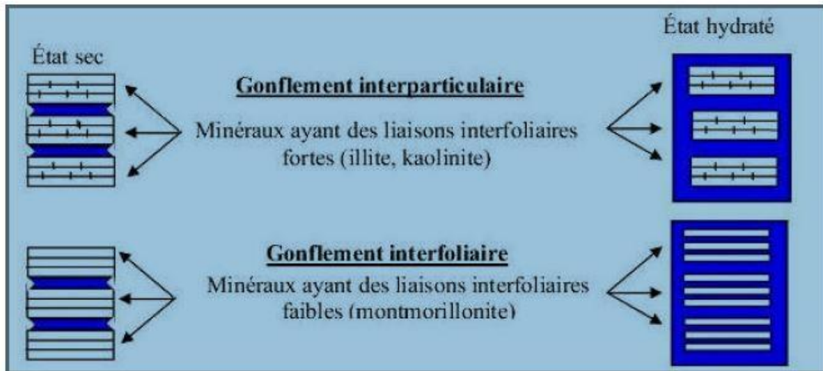
Figure II.3-3: Mécanisme de gonflement des argiles par hydratation (Harrat Mohamed, 2007) cité par (BENAISSA Mohamed, 2011)
