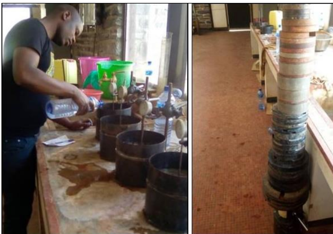
Figure IV.7-1 : Saturation des échantillons avec différents sels et lecture du gonflement (à gauche) et évaluation du tassement (à droite).
