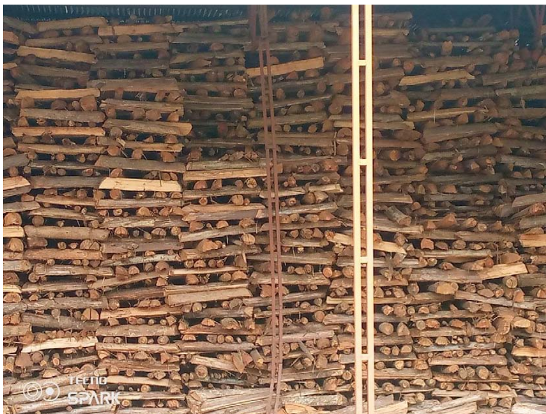
Figure 14 : Stockage du bois pour la réduction de l'humidité à l'usine à thé de Tora (Auteur, décembre 2025)
