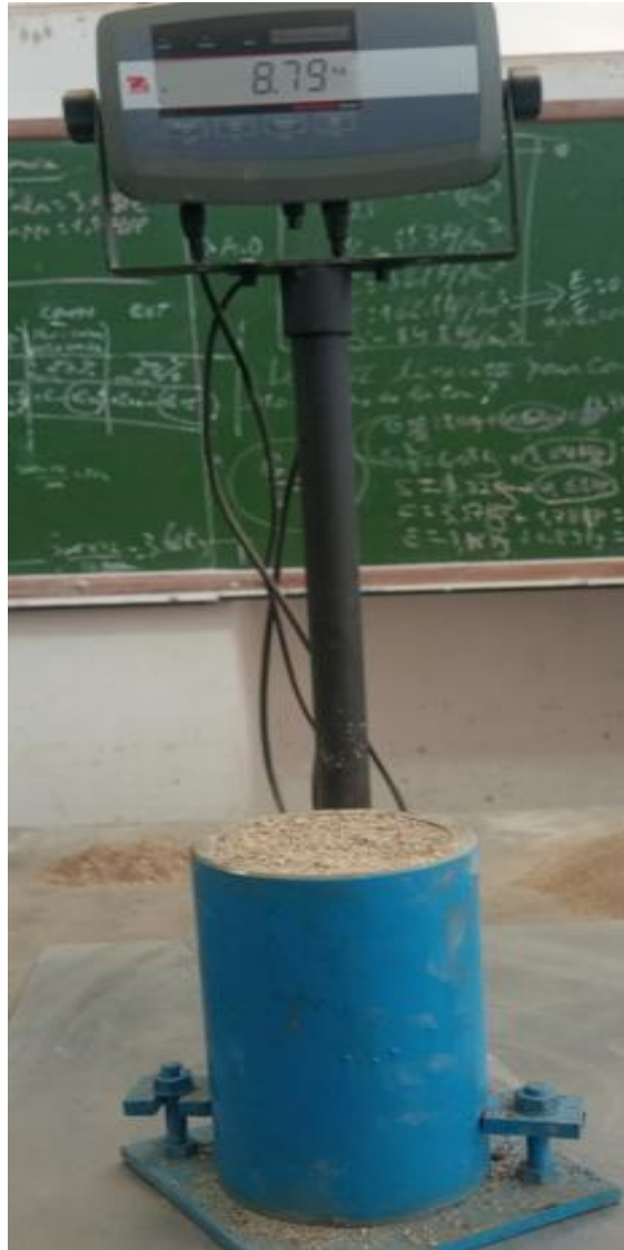
Figure III-2 : Mesure de la masse volumique apparente du sable
