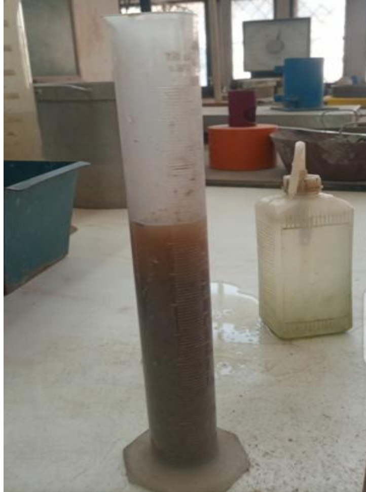
Figure III-1 : Mesure de la masse volumique absolue du sable
