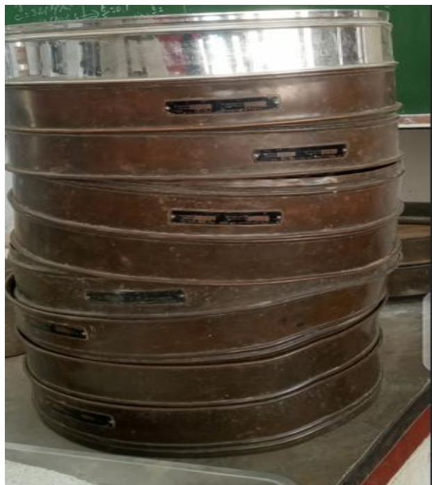
Figure III-6 : Série des tamis utilisée pour faire l'analyse granulométrique selon la norme NF EN 993-1
