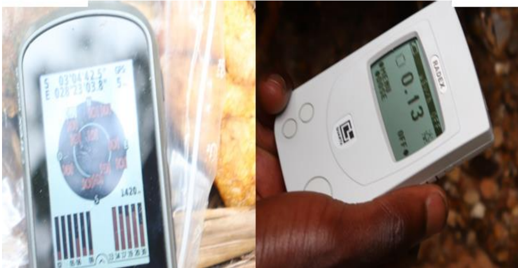
Figure 1 : (a) Prélèvement des coordonnées géographiques sur site avec GPS de marque GARMIN et (b) mesure de la dose effective avec un compteur Geiger-Müller de marque RQDEX
