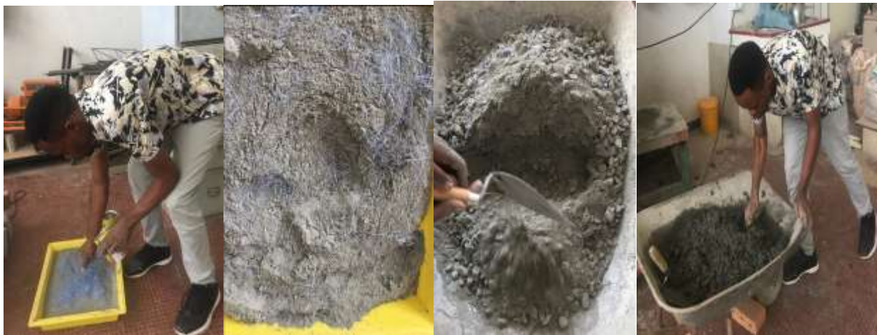
Figure IV.13 : Malaxage du béton
