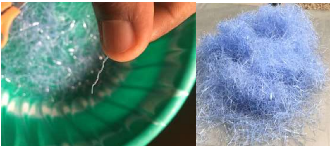
Figure IV.8 : Les fibres ( déchets plastiques des bouteilles kinju)
