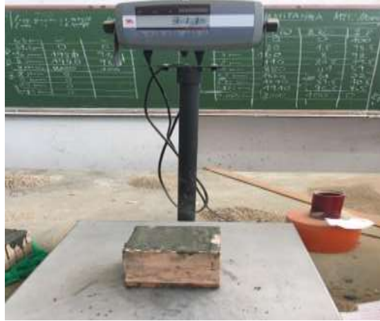
Figure IV.15 : Mesure de la masse volumique à l'état frais
