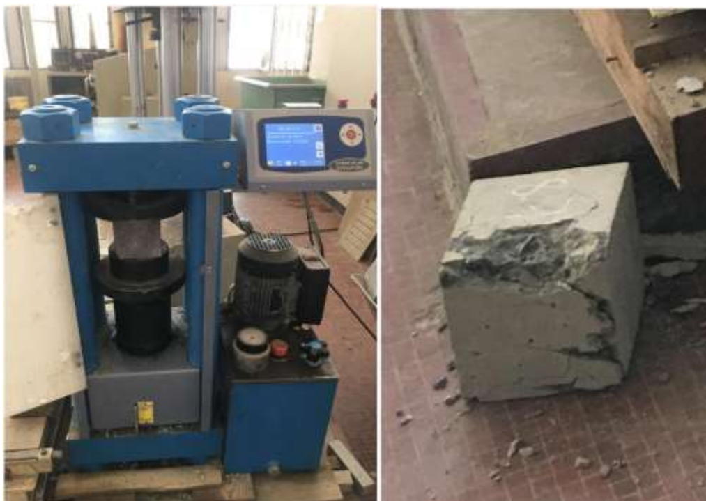
Figure IV.19 : Essai de résistance à la compression
