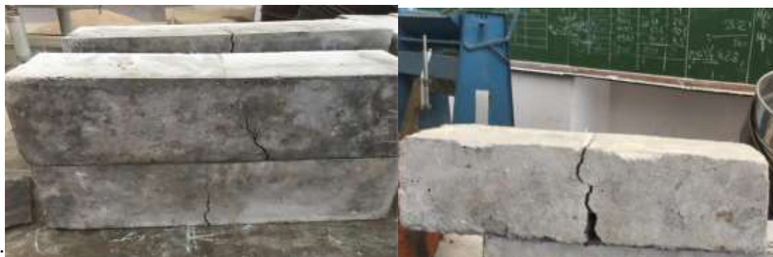
Figure V.6 : Béton fibré après écrasement et béton sans fibre après écrasement
