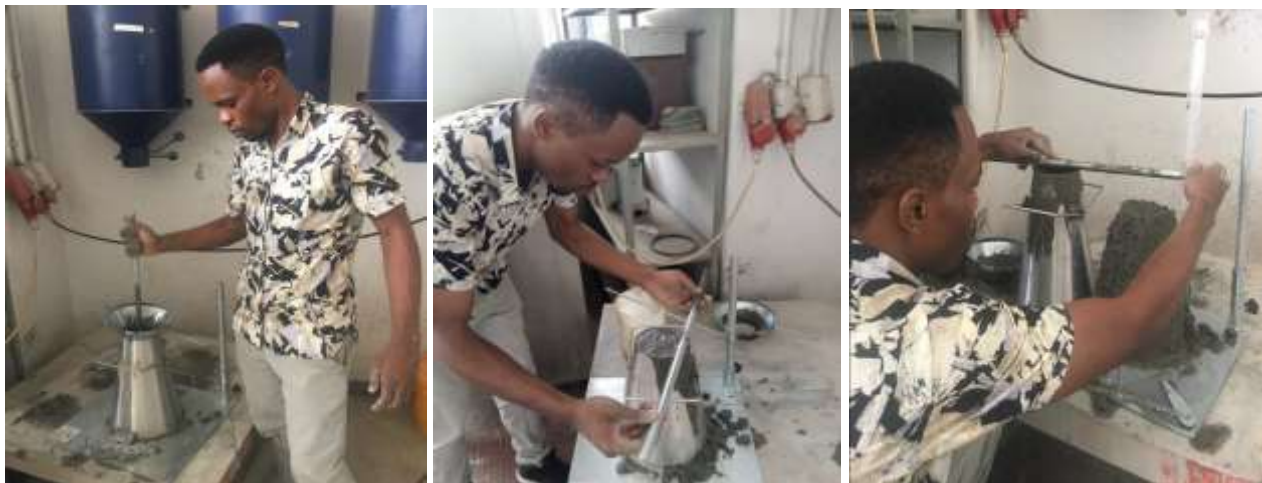
Figure IV.14 : Mesure de l'affaissement au cône d'Abrams
