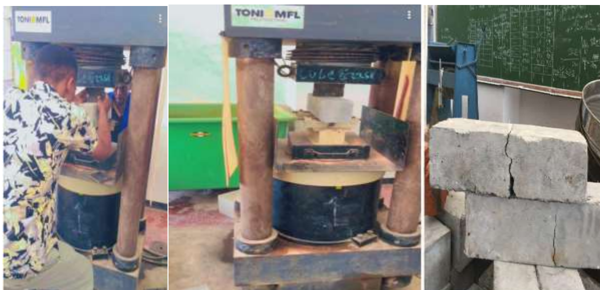
Figure IV.20 : Essai de résistance à la traction par flexion
