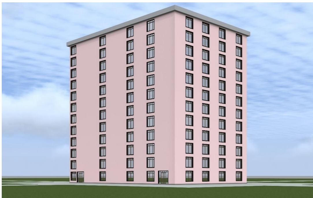
Figure 15-Représentation 3D, espacement des poteaux de 6m en X
