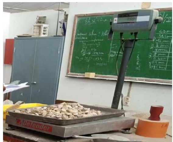
Figure II.3 : photos d'Analyse granulométrique de granulats roulés recyclés
