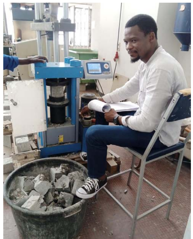
Figure III.1 : Détermination de différentes résistances à la compression après l'écrasement à la presse hydraulique.
