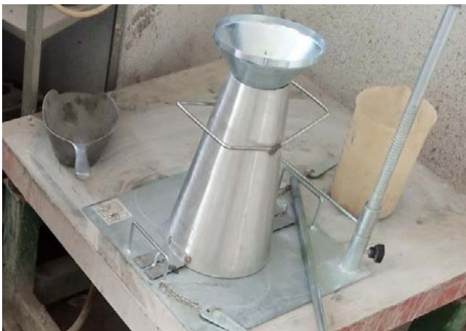
Figure II.11 : Appareillage de cône d'Abrams
