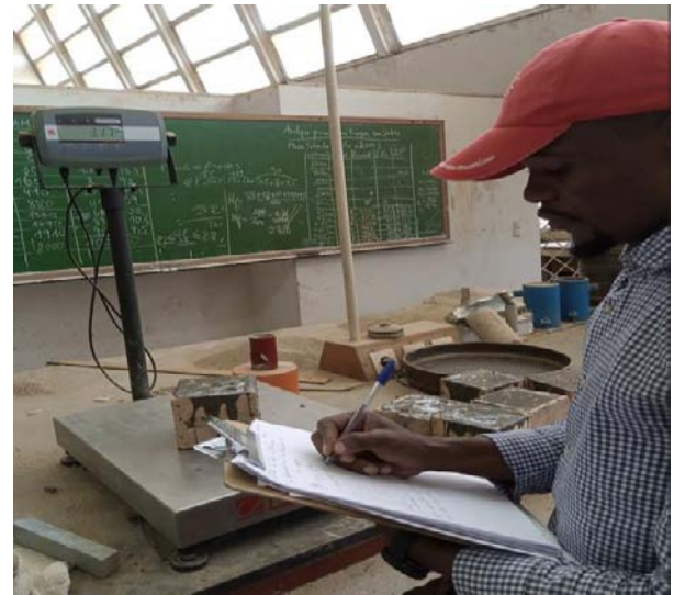
Enregistrement de masse de béton frais
