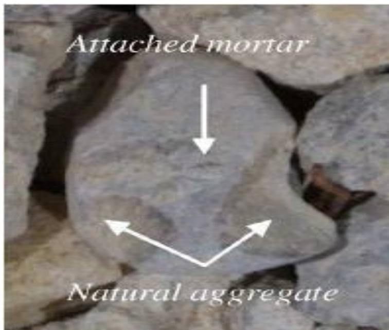
Figure I.2: Compositions des granulats recyclés de béton
