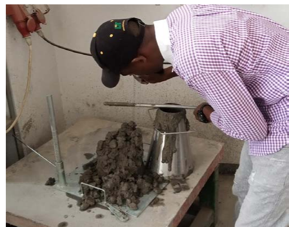
Figure II.11 : Appareillage de cône d'Abrams
