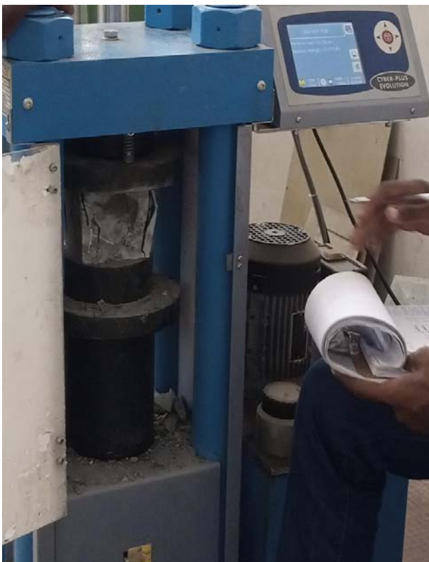
Figure III.1 : Détermination de différentes résistances à la compression après l'écrasement à la presse hydraulique.
