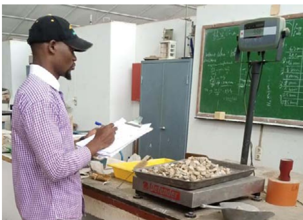
Figure II.3 : photos d'Analyse granulométrique de granulats roulés recyclés
