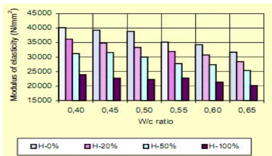
Figure I.7: Relation entre les modules élastiques des bétons recyclés et Conventionnels à différent
