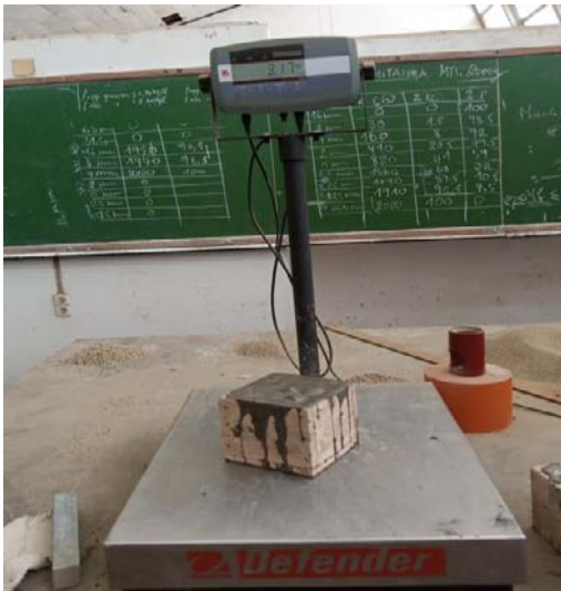
Masse de béton frais
