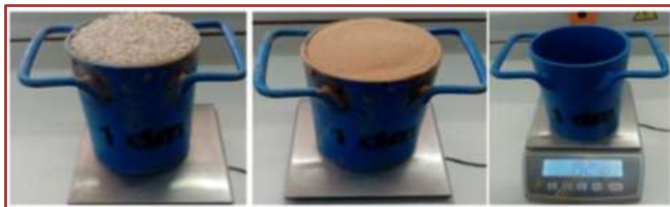
Fig.9. Essai masse volumique du sable (Abbadi Fatima, 2019)
