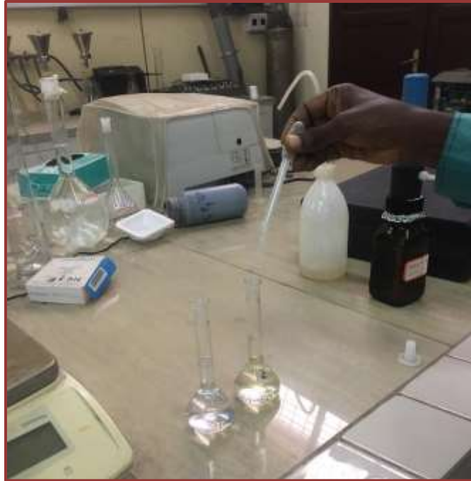
Fig.18. Coloration jaunâtre de l'échantillon (présence d'ions ammonium)
