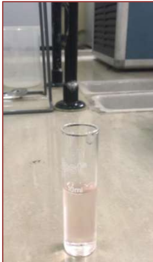
Fig.16. Coloration rosâtre de l'eau (présence des ions chlorures)
