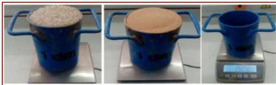
Fig.9. Essai masse volumique du sable (Abbadi Fatima, 2019)
