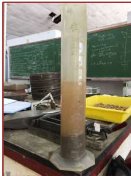
Fig.10. Essai de la masse volumique absolue
