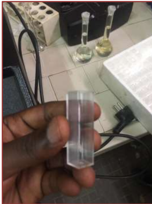
Fig.19. Tube pour spectrophotomètre
