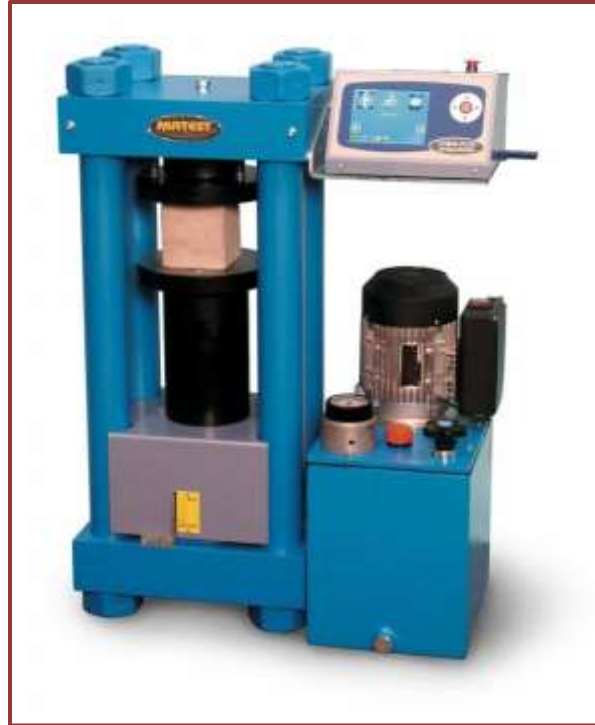
Fig.8. Machine Matest de compression du béton
