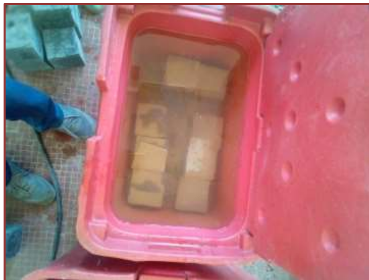
Fig.11. Cure des éprouvettes dans l'une des eaux prélevées
