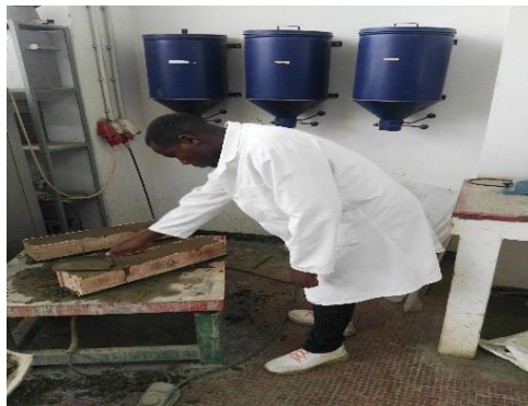
Figure II.7 La mise en place du béton
