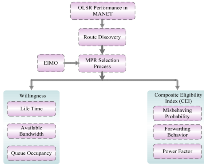
Figure 11. Architecture du modèle EIMO-ESOLSR dans MANET
