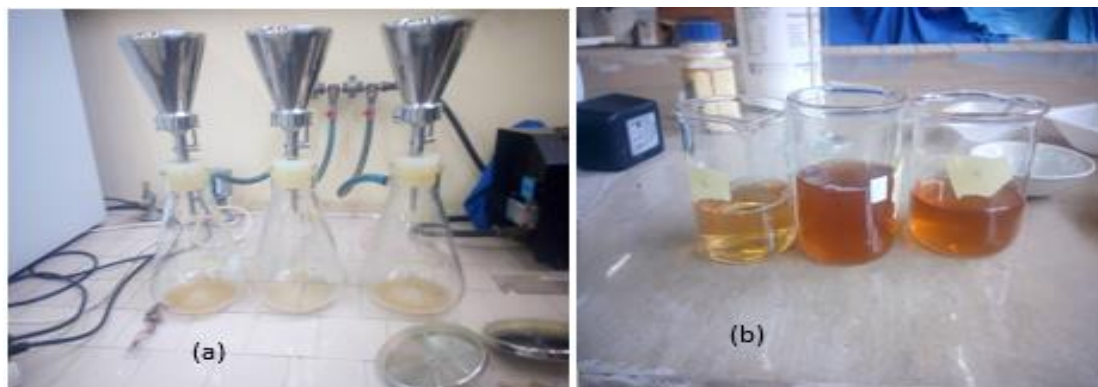
Figure 2.7 : a) Pompe à vide pour la filtration b) Boues filtrées
