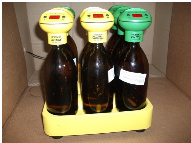
Figure 2.9 : Dispositif expérimental de mesure de la DBO 5
