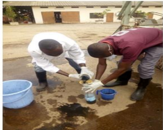
Figure 2.5: Transvasement de l'échantillon dans les flacons en plastique
