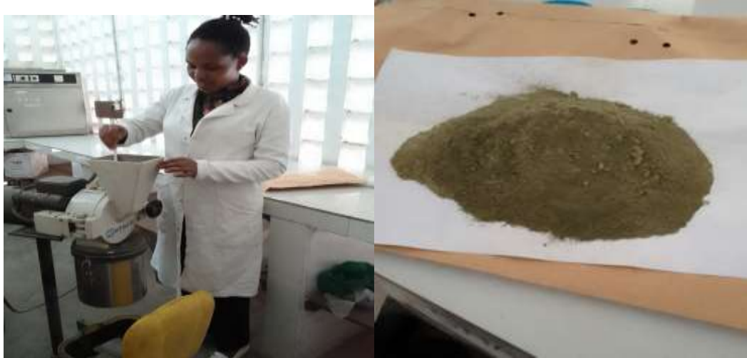
Figure 2 : Broyage des feuilles d'amarantes à l'aide d'un broyeur pour avoir une farine
