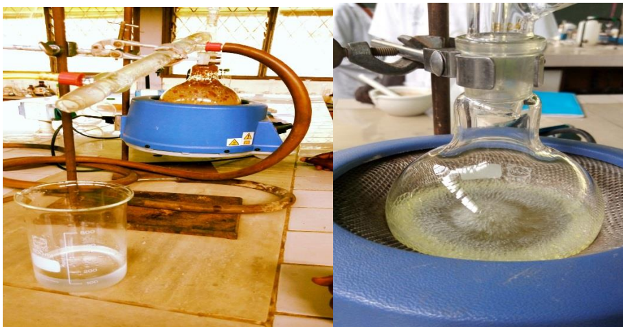
Figure 8 : Extraction des huiles essentielles par hydro-distillation
