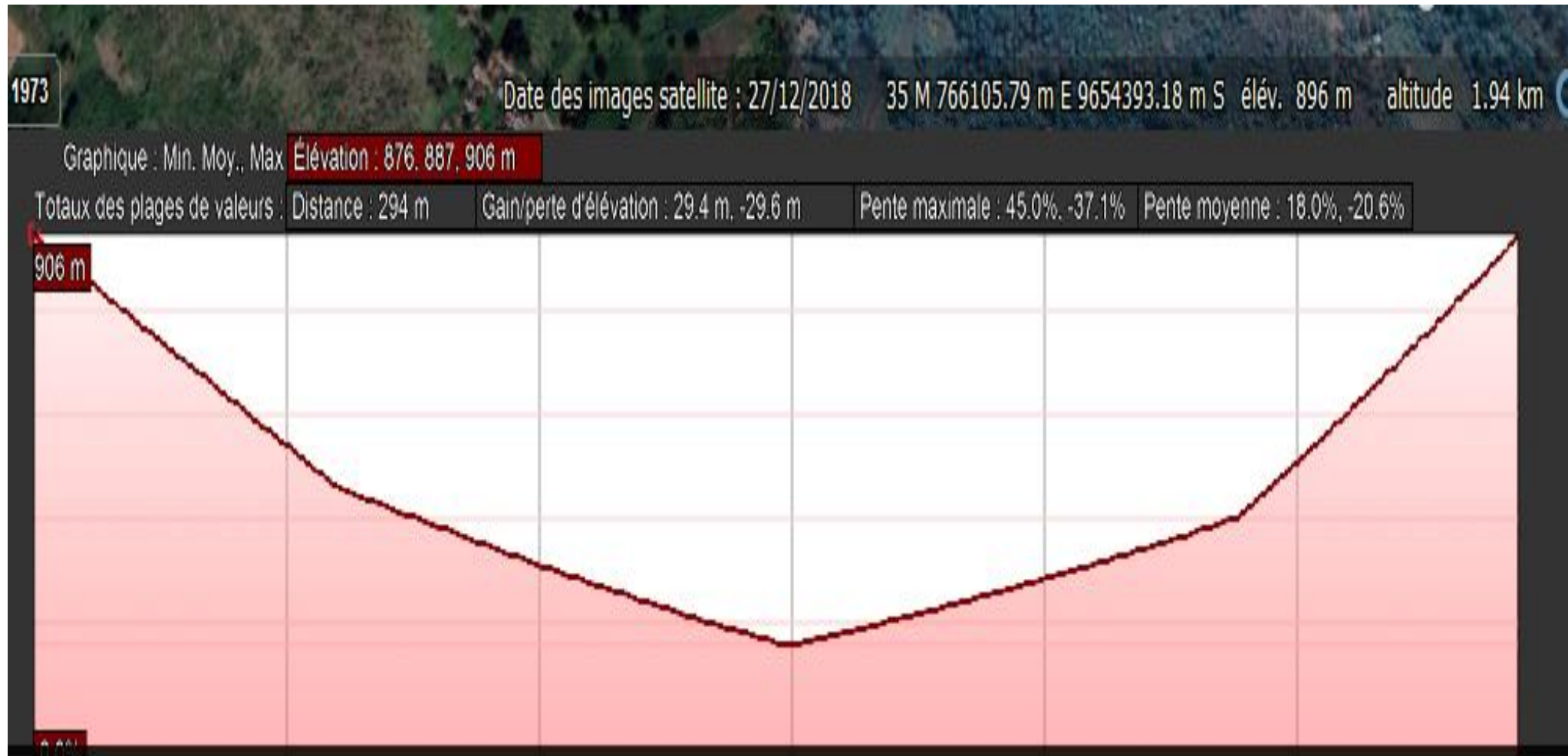
Figure V-2:profil en travers à l'endroit du barrage
