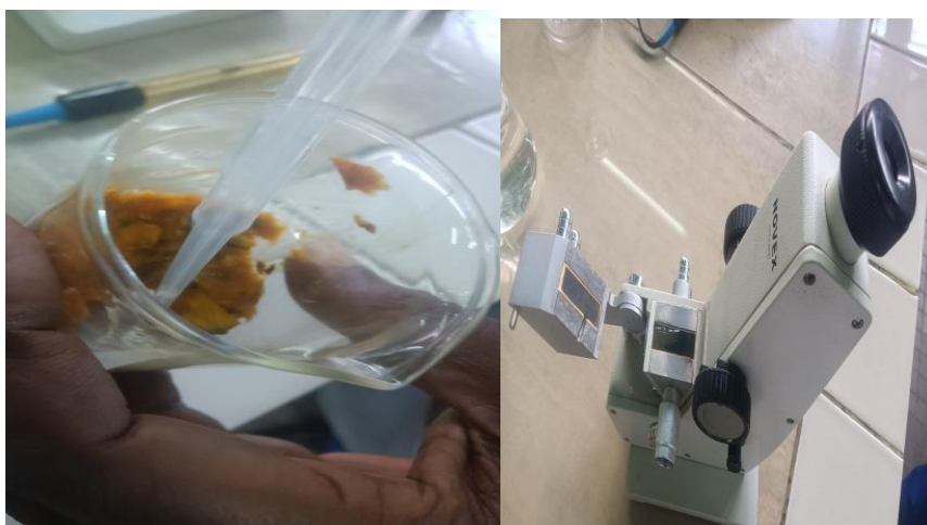
Figure 4 : Détermination de l'indice de réfraction
