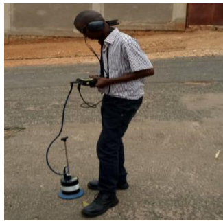
Figure 7: Primayer, appareil acoustique de détection des fuites.
