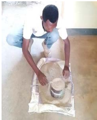
Remplissage du sable dans le récipient de 2000ml
