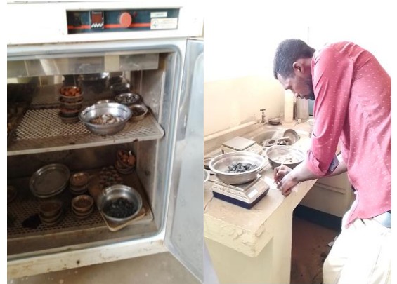
Détermination de la masse sèche des échantillons
