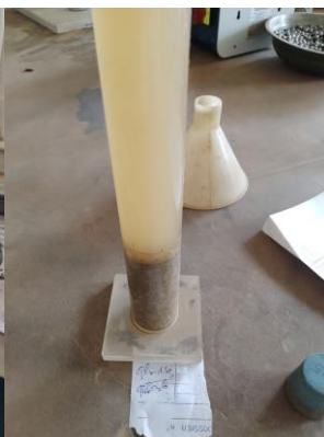
Mise du sable, puis mélange avec l'eau dans une éprouvette graduée
