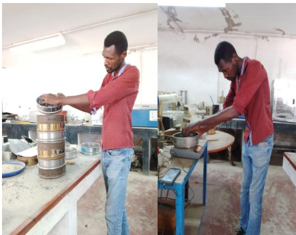
Tamissage et pesée de granulats pour l'essai micro-Deval
