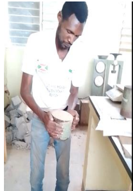
Pesée de la masse de l'échantillon + récipient
