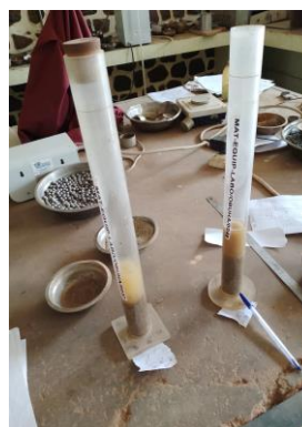
Attente de la sédimentation (20 min)
