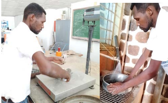
Pesée, lavage et essuyage des granulats (de 1000g de l'échantillon)
