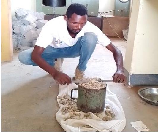
Remplissage du récipient de 5000ml
