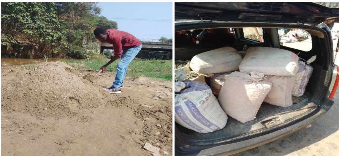
Prélèvement et transport d'échantillons (sable et gravier) de la rivière Ntakangwa. Photo du 22/8/2025
