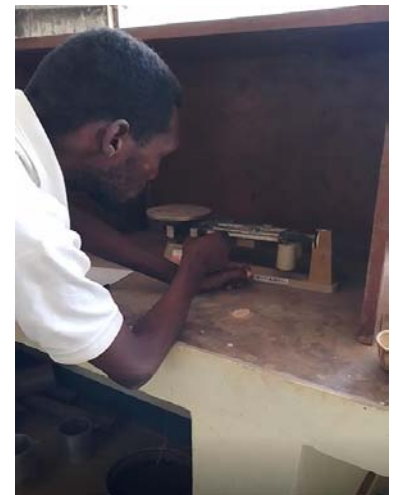
Lecture de la densité absolue par pesée hydrostatique
