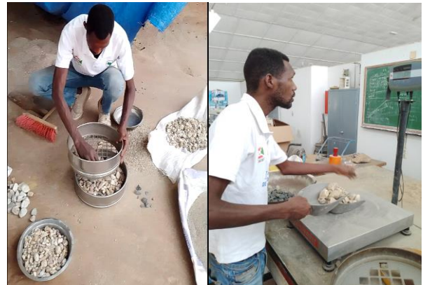
Tamisage successif sur les tamis de 25 et
