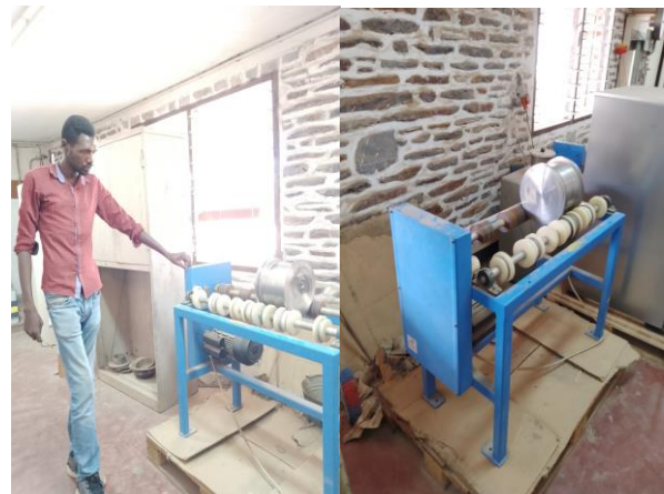
Fixation de l'appareil micro-Deval
