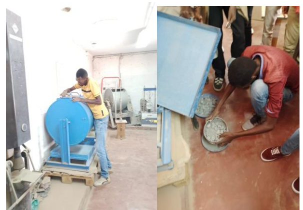
Fixation et mise en marche du tambour de Los Angeles
