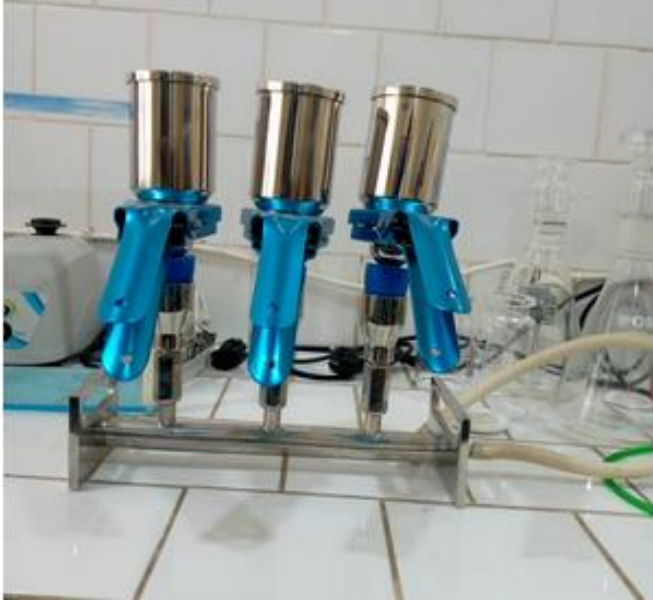
Photo 12 : Rampe de filtration sous vide
